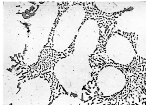
Фиг. 2. Микроструктура на изследваните сечения в лято състояние, х 500: а) вътрешен реборд; б) ребро; в) главина; г) външен реборд
